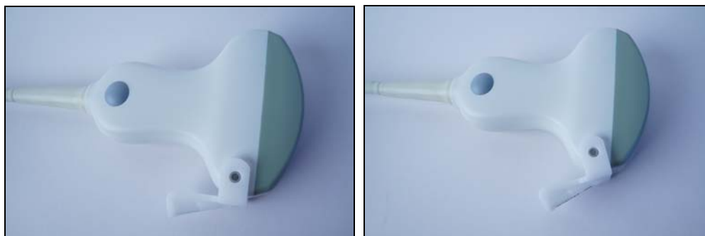
Obrázek 5. Punkce je možná při zaváděcím úhlu 18° (vlevo) nebo při širším zaváděcím úhlu 36,5° (vpravo). Nástavec je zde zobrazen bez návleku snímače.
