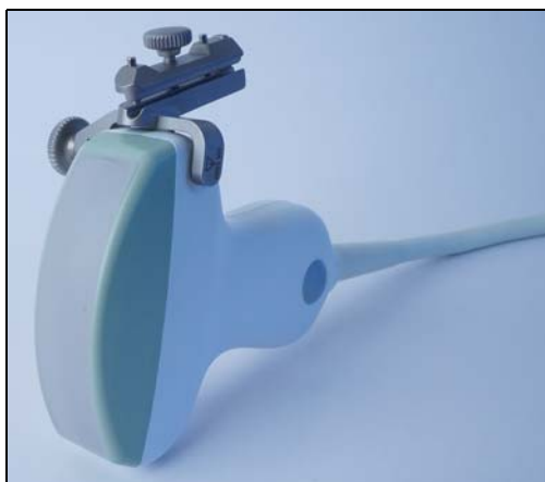
Obr. 3. Punkční nástavec UA1250 namontován na snímači 6C2.
