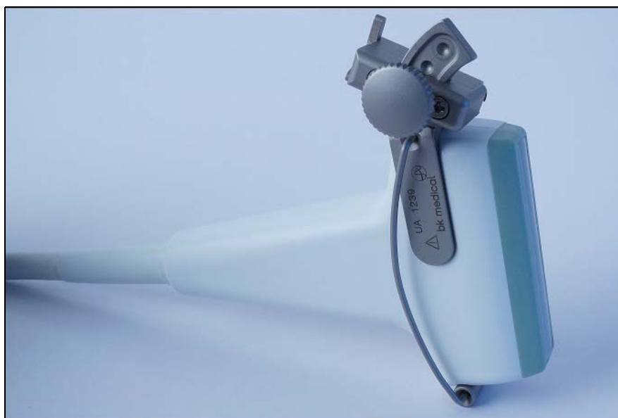
Obrázek 3. Montáž punkčního nástavce UA1239 (znázorněno bez krytu).
